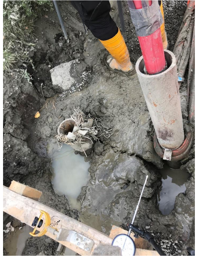
Figur 2-5: Påltoppsrörelse vid maximal belastning, Cirkulär 2
