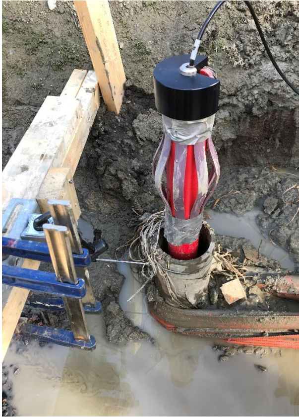
Figur 2-4: Påltoppsrörelse vid maximal belastning, Cirkulär 1
